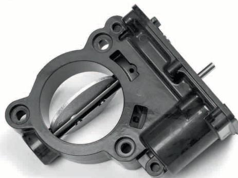
Die neue Anlage von LTW und Vögele montiert das Gehäuse, die Achse und die Drosselklappe sowie einen Fixierstift in nur 13 Sekunden.
