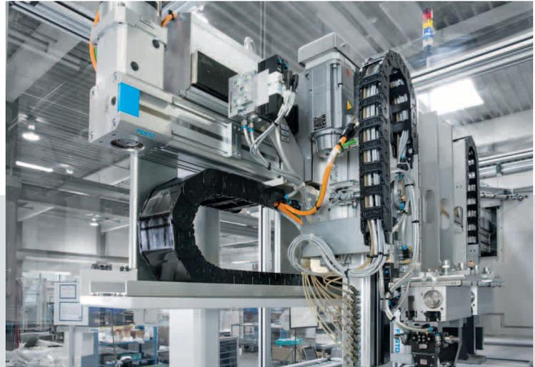
**Integrierte Automation:** Die Teilebeladung übernimmt ein Linienportal von Festo mit entsprechenden Greifern. (oben)
