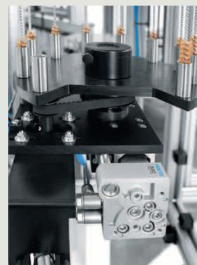
**DGC Achsen führen** das Bürstenmagazin von der Magazinbestückung der Bearbeitung zu.
