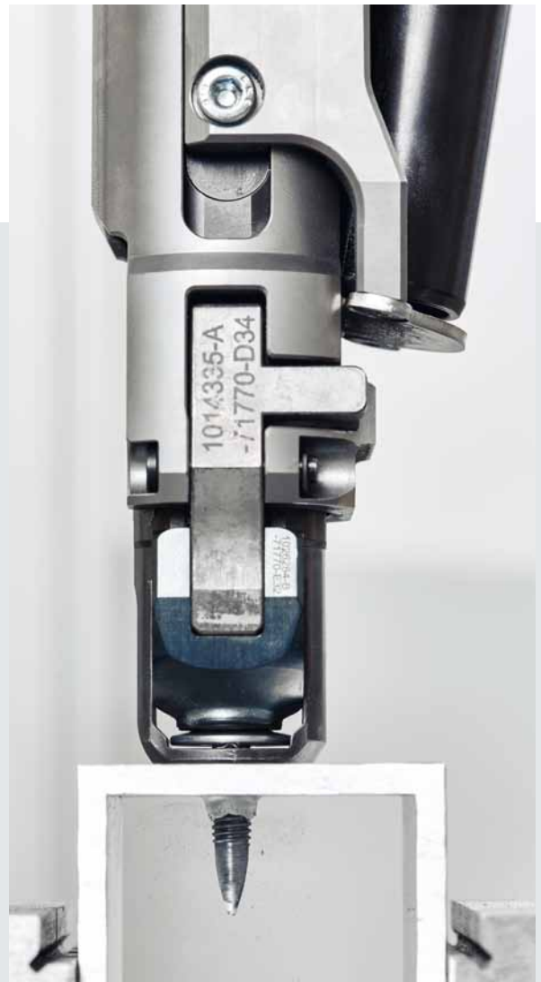
Funktionale Leistungsträger: Fließformschrauben verbinden unterschiedlichste Materialien in Sekundenschnelle ohne Vorloch.
