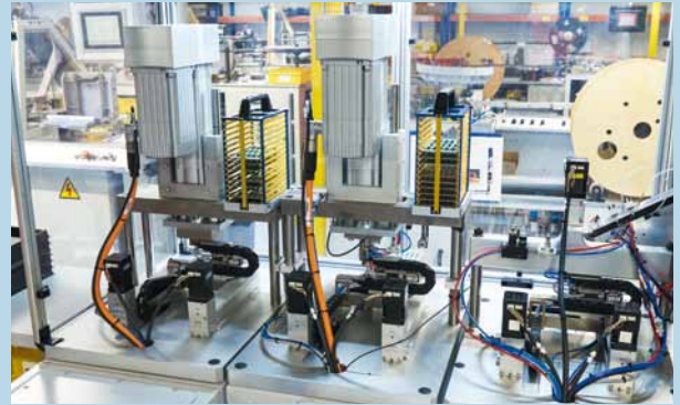
Modular aufgebaut: die drei Stationen der Gecko-Montagelinie zum Einschließen, Einpressen und Biegen der Kontaktstifte – konzipiert aus Standardkomponenten von Festo.
