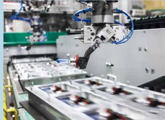
Hohe Dynamik: Tripods vom Typ EXPT sorgen für den schnellen Verpackungsprozess von Autolampen.
