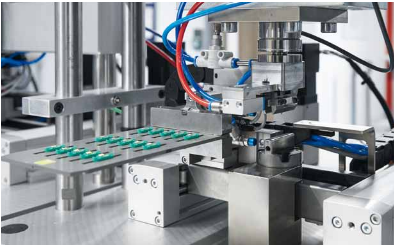
Dynamisch und präzise: Das kompakte Handlingsystem YXMx sorgt für die XY-Bewegung der Werkstücke unter der Servopresse.
